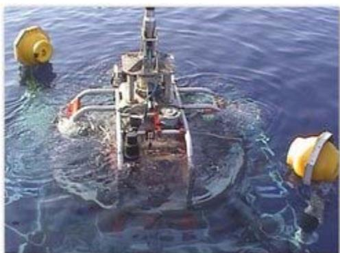
Adesso gli tsunami fanno un po' meno paura. Infatti nel Golfo di Cadice a oltre 3.200 metri di profondità è stata installata la stazione abissale "**Geostar**" che potrà prevedere gli tsunami. Sarà così possibile evitare le tremende tragedie quando le onde anomale colpiranno coste urbanizzate e densamente popolate. Fino ad oggi infatti si utilizzavano dei **mareografi** che potevano segnalare uno tsunami solo quando era molto vicino alla terra.
