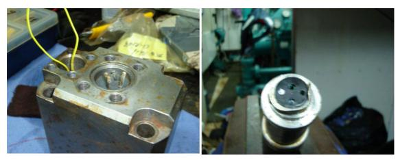
Figura All.3.- Rotura de la solenoide y el pigtail cañón nº 2 de 1000 cu.in
