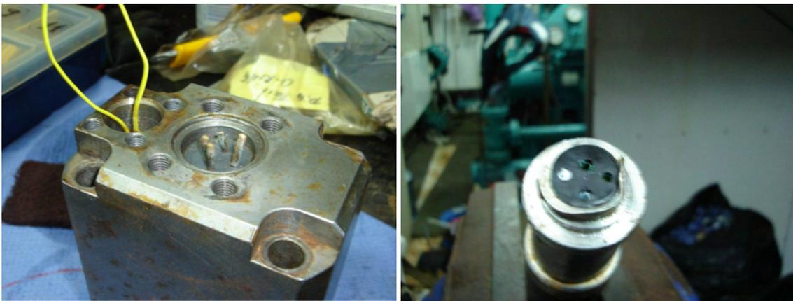
**Figura AII.3.-** Rotura de la solenoide y el pigtail cañón n° 2 de 1000 cu.in
